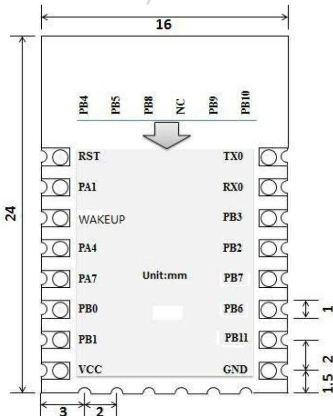
图 2-1 模块引脚排列及尺寸图
